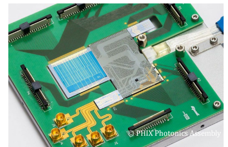
5G以降のネットワーク向けの光利用 テラヘルツトランシーバー (EU TERAWAY)
